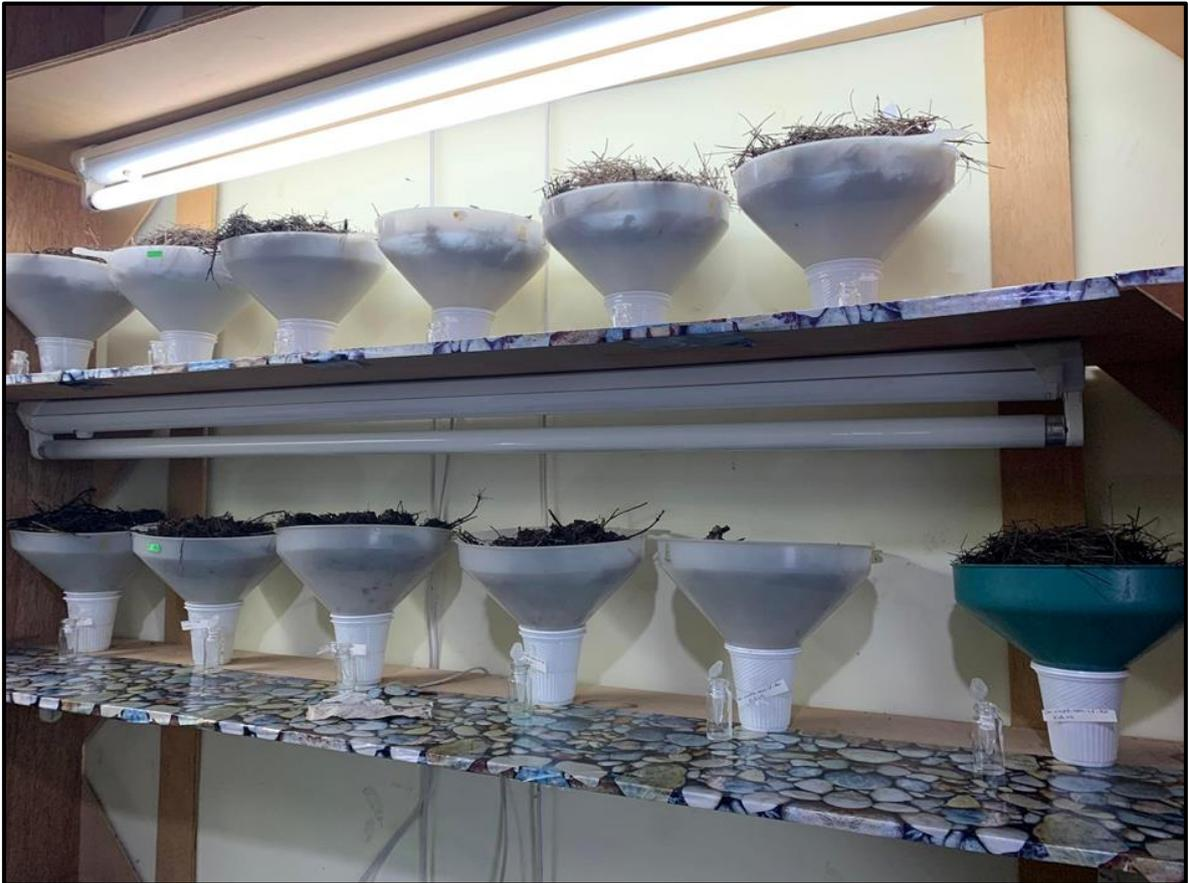
**Figure 20.** Appareil de Berlese pour l'extraction des Collemboles (Photo originale).
